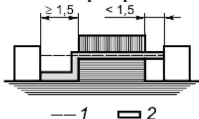
Условие - В промежутке имеется выступ, представляющий собой не скрепленное клеем соединение, с канавкой шириной менее 1,5 мм с одной стороны и с канавкой шириной равной или более 1,5 мм с другой стороны.
