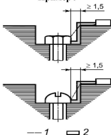
Зазор между головкой винта и стенкой углубления достаточно широкий, поэтому его следует учитывать
