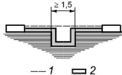
Условие - В промежутке имеется канавка с параллельными сторонами любой глубины  $d$ , шириной, равной или более 1,5 мм.
