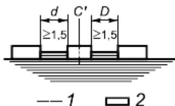
$C'$  - проводник, расположенный в промежутке между двумя другими.
