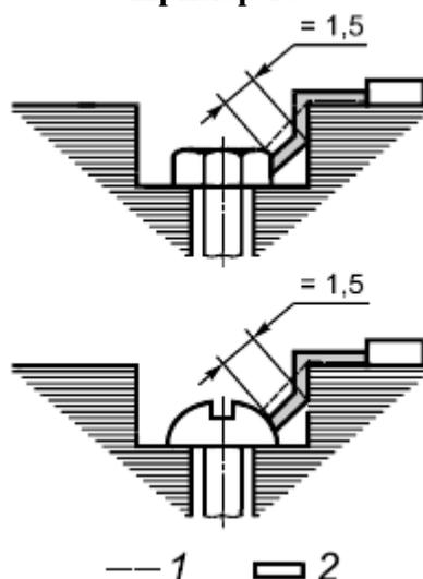
Зазор между головкой винта и стенкой углубления слишком узкий, чтобы его учитывать. Измерение пути утечки по поверхности следует начинать от точки на стенке углубления, отстоящей от винта на расстоянии 1,5 мм.
