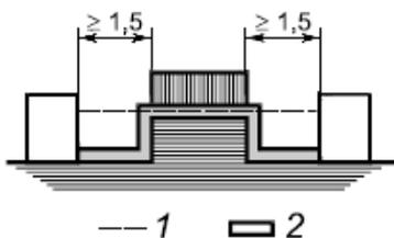
Условие - В промежутке имеется выступ, представляющий собой не скрепленное клеем соединение, с канавками, шириной, равной или более 1,5 мм с каждой стороны.
