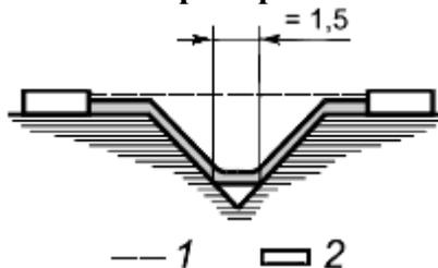
Условие - В промежутке имеется V-образная канавка шириной более 1,5 мм.
