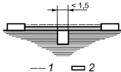
Условие - В промежутке имеется канавка с параллельными или сходящимися сторонами любой глубины, шириной менее 1,5 мм.
